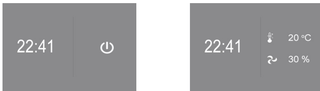
Pav. 22. Pultas LCD ekranėliu budėjimo režime, išjungtas ir veikiantis įrenginys
